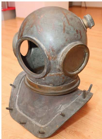
Двенадцатиболтовый водолазный шлем 1929 г. выпуска.
